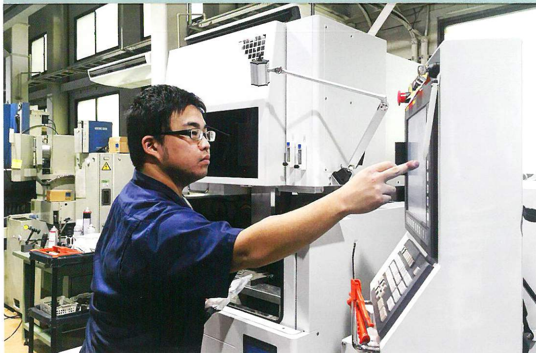
ワイヤ放電加工で、複雑な形状の加工が可能に
